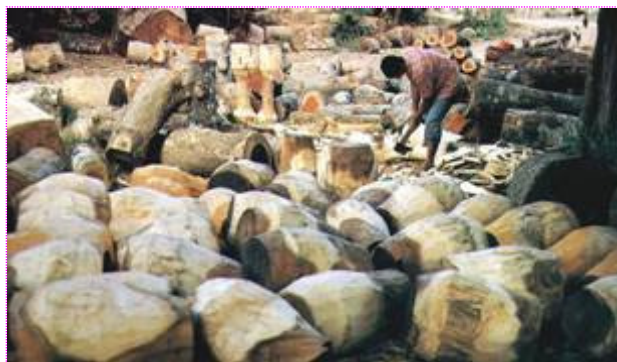
ภาพที่ 3 การถากท่อนไม้ก่อนนำขึ้นแท่นกลึงช่วยให้กลึงท่อนไม้ได้ง่ายและรวดเร็ว
